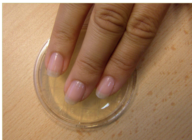
Obrázek 14: Otisk z mikrobiologicky testovaného povrchu s pomocí takzvaného kontaktního (otiskového) agaru. Po expozici se agar nechá inkubovat v termostatu a následně se narostlé bakteriální kolonie spočtou, typizují a následně přepočítají na jednotku plochy (foto: J. Bzdil).
