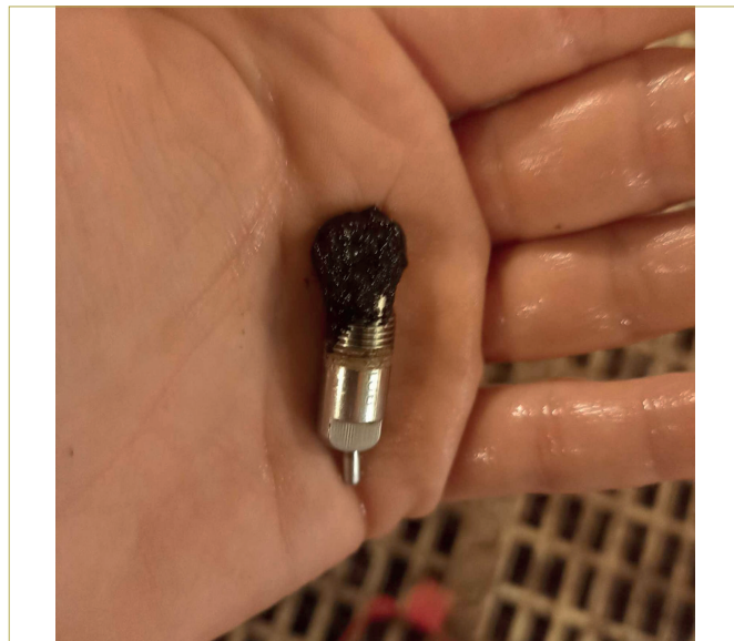
Obrázek 6: Bakteriální biofilm může ucpávat i niplíky kapkových napáječek (foto: V. Sládeček).
