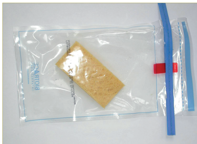
Obrázek 13: Odběrová souprava se stěrkou a abrazivní houbičkou, kterou lze stírat vyšetřované povrchy v terénu a v laboratoři mikrobiologicky vyšetřit (foto: J. Bzdil).
