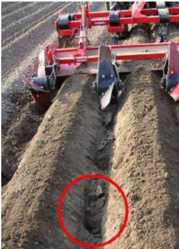
Zařízení na hrázkování brambor s detailem hrázky v meziřadí brambor
