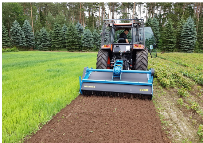
Obr. 2: Rýčový stroj Imants zajišťující jedním pojezdem střední až hlubokou přípravu půdy včetně optimálního způsobu zapravení zeleného hnojení.
