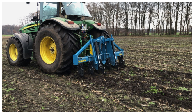
Obr. 1: Hlubokou přípravu půdy prováděná pomocí podrýváků Imants Culter – zde samostatně (lze i v agregaci s rýčovým strojem).
