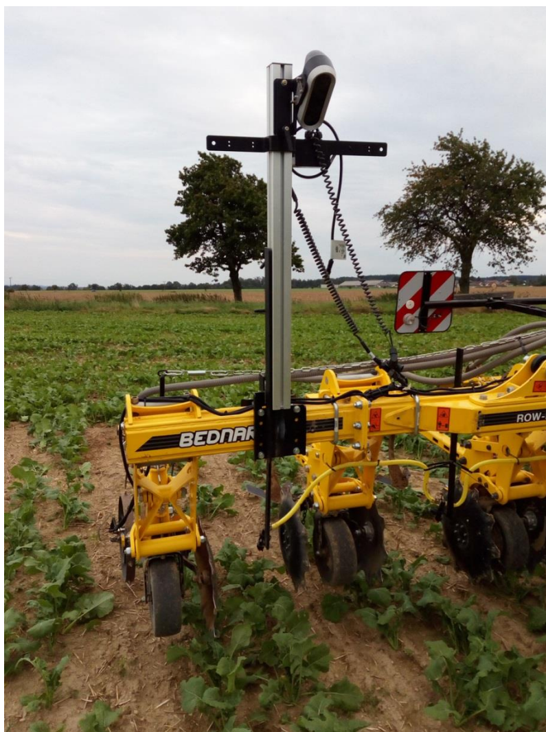
Obr. 5. Plečka pro zpracování meziřádků naváděná pomocí optických senzorů (foto: Brant)
