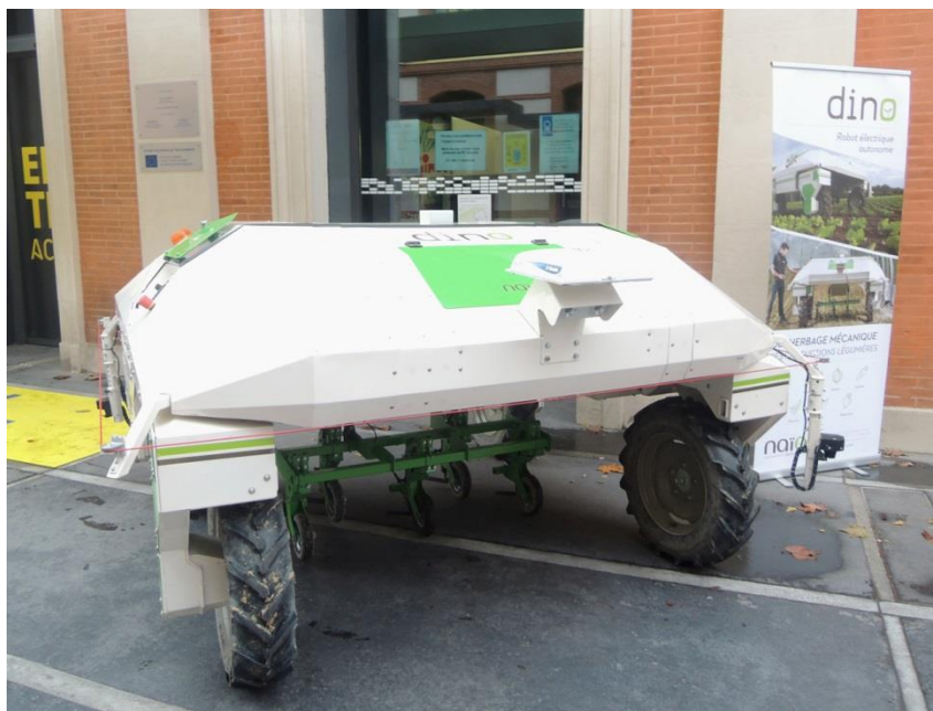
Obr. 7. Polní robot Naïo DINO (foto: Kroulík)
