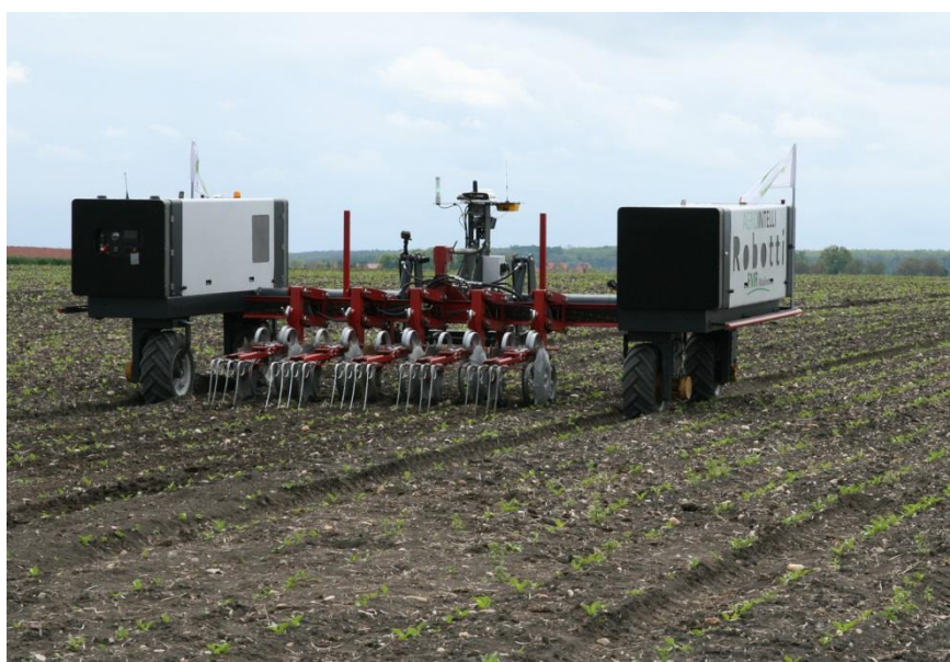
Obr. 8. Polní robot Agrobot Robotti (foto: Kroulík)
