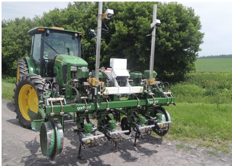
Obr. 6. Plečka Garford umožňující zásah proti plevelům i uvnitř řádků plodiny (foto: Kroulík)
