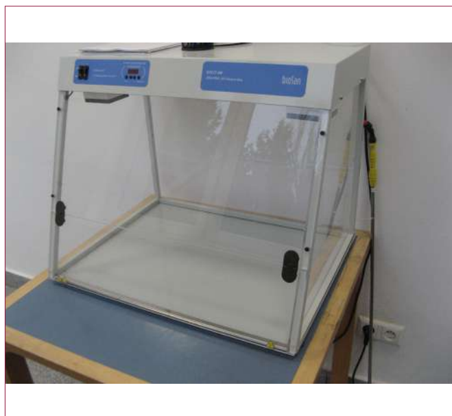
Obr. 12. Dezinfekční UV komora
