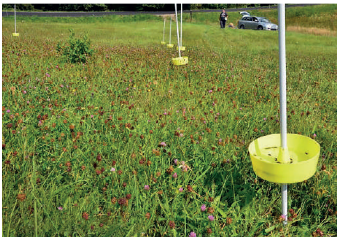
Obr. 60. Žluté misky jsou využívány k monitoringu létajícího hmyzu. Foto: Eva Korábková.
