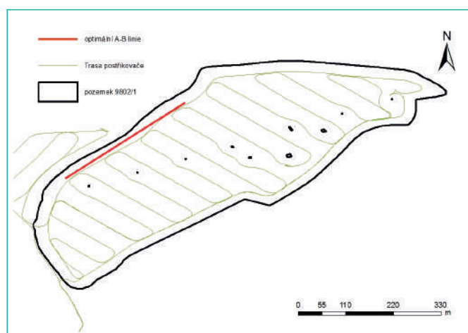
Obr. 28: Modelové trajektorie jízd pracovních strojů a původní jízdy pořízené záznamem (Kroulík).
