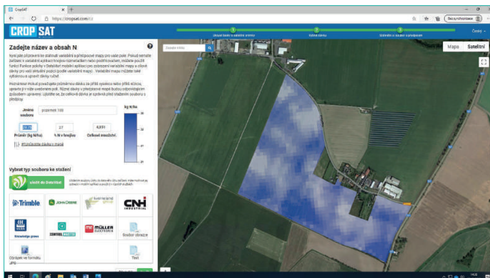
Obr. 20: Stanovení vegetačního indexu pro vybraný pozemek a datum pořízení snímku (Kroulík).
