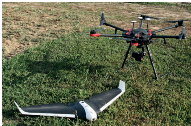
Obr. 74: Konstrukční řešení používaných bezpilotních prostředků, delta křídlo a multikoptéty. (foto Kroulík)
