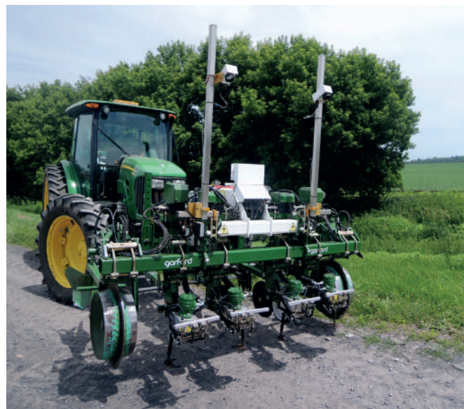
Obr. 64: Poloautonomní kultivátor pro mechanickou likvidaci plevelů. (foto Kroulík)
