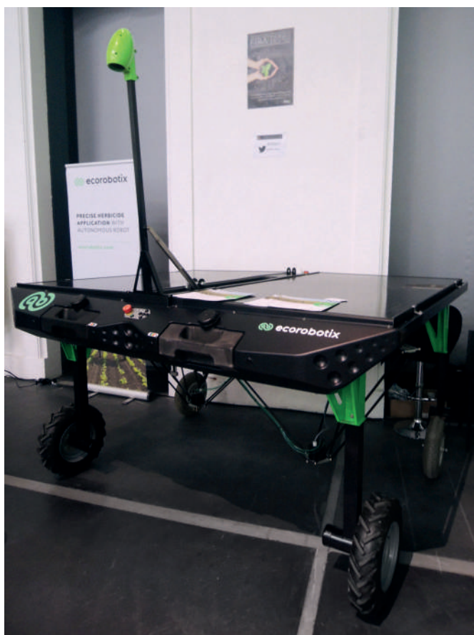
Obr. 71: Robotická platforma Ecorobotix. (foto Kroulík)
