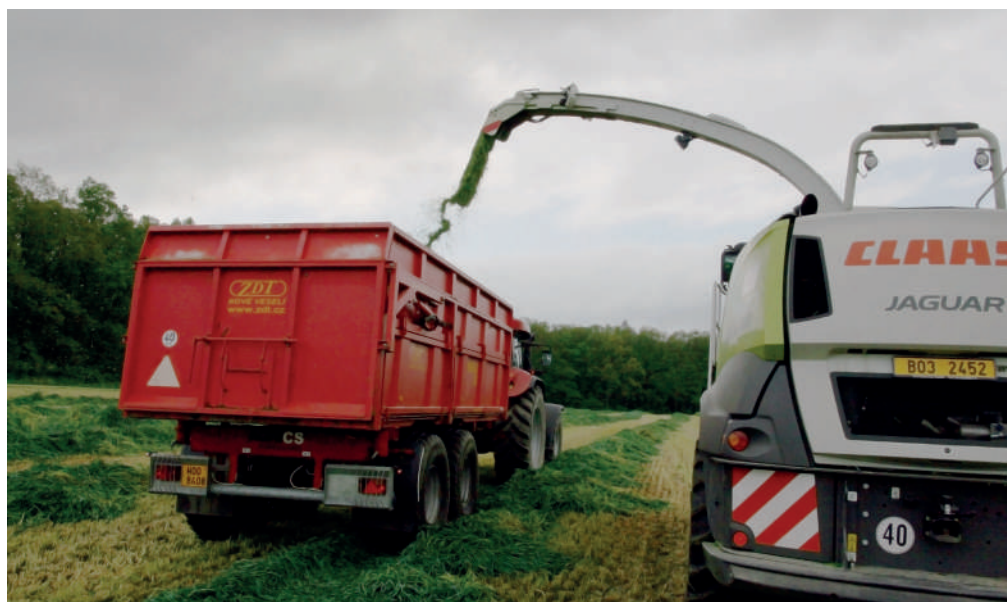
Obr. 6: Sklizecí řezačka Claas se zabudovanou senzorovou technikou. (foto Kroulík).
