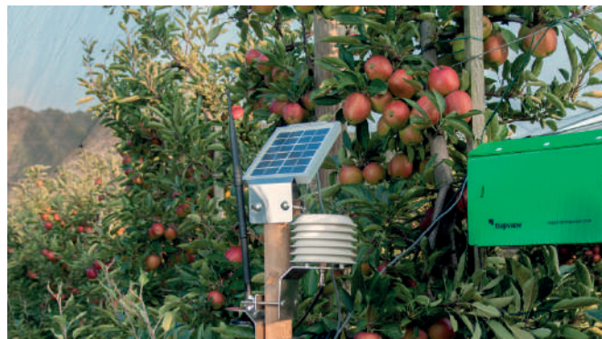
Obr. 58: Automatizovaný feromonový lapač TrapView integrovatelný do IoT ( http://trapview.blogspot.com/2016/12/modelling-of-up-to-three-different.html )
