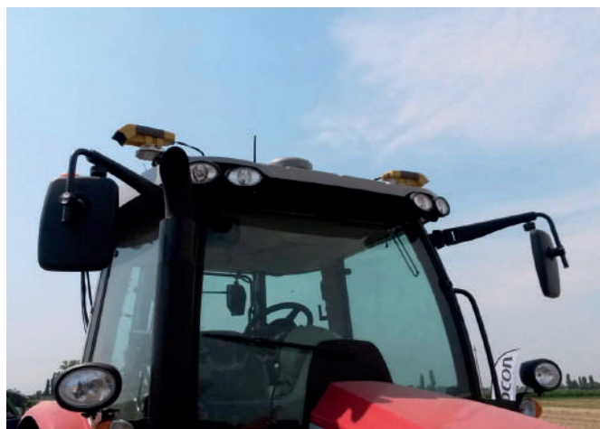
Obr. 43: Příklady technického řešení optických senzorů a jejich zavěšení nebo montáž na stroji: Yara N-sensor, Fritzmeier/ Claas ISARIA, AgLeader OptRx, Trimble Green Seeker, Topcon CropSpec (foto Kroulík).
