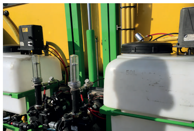
Obr. 62: Detail prototypu postřikovače se 2 nádržemi (bílé) na koncentráty biocidů, směšovací zařízením a cisternou na vodu (žluté) (foto Jan Lukáš)
