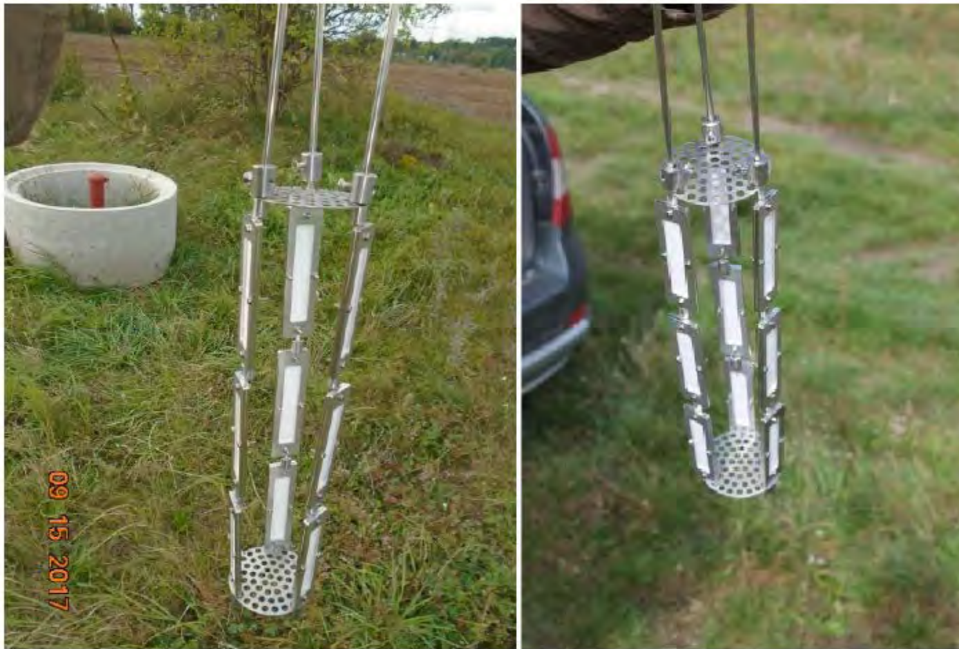
Obrázek 1: Konstrukce pro uchycení dozimetrů pro mezilaboratorní test
